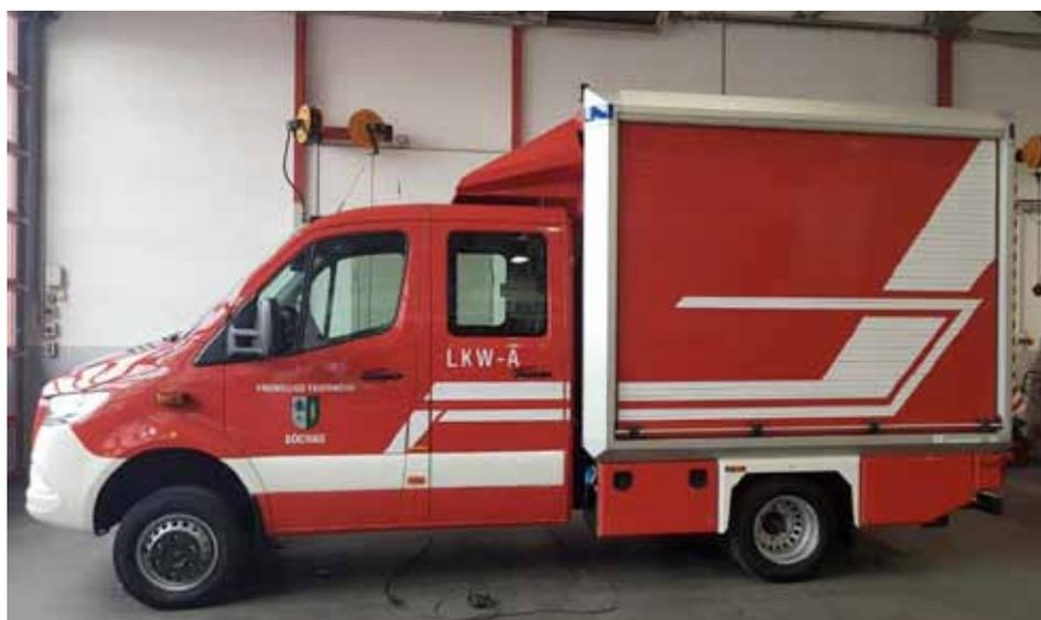
Am 25. September wurde unser neues Feuerwehrfahrzeug mit der Bezeichnung LKW-A an die Freiwillige Feuerwehr Söchau überstellt. Dabei handelt es sich um einen Mercedes Sprinter mit Kastenaufbau, Allradantrieb und einer Ladebordwand zum Be- und Entladen der Rollcontainer.
